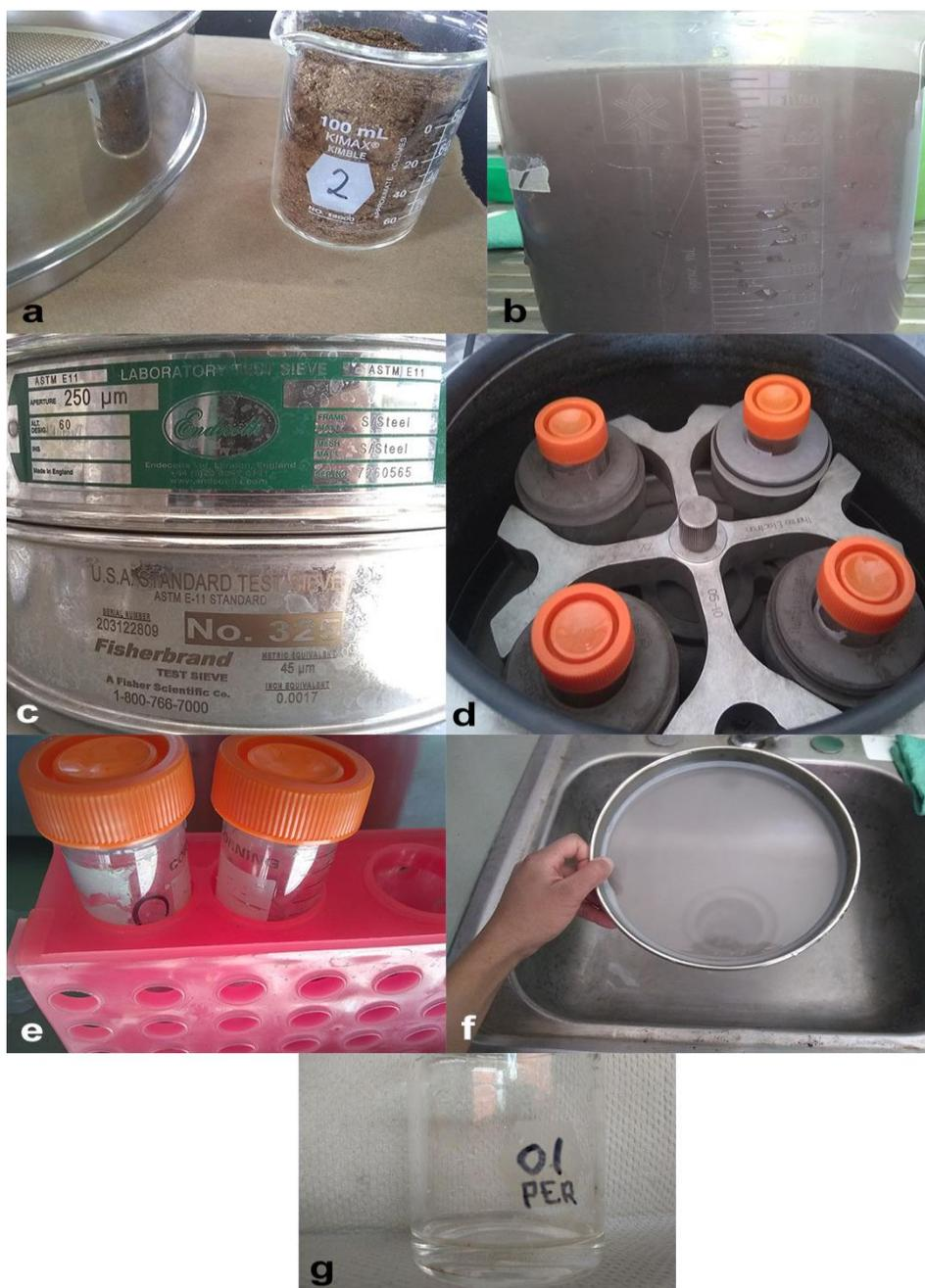
**Figura 5.** Procedimiento general para la extracción de nematodos de suelo: a) tamizado en seco (1.7 mm), b) suspensión de la muestra, c) tamizado en húmedo (250 µm y 45 µm), d) centrifugación, e) suspensión con azúcar, f) centrifugación y tamizado en húmedo (25 µm), g) recuperación del sobrenadante.
