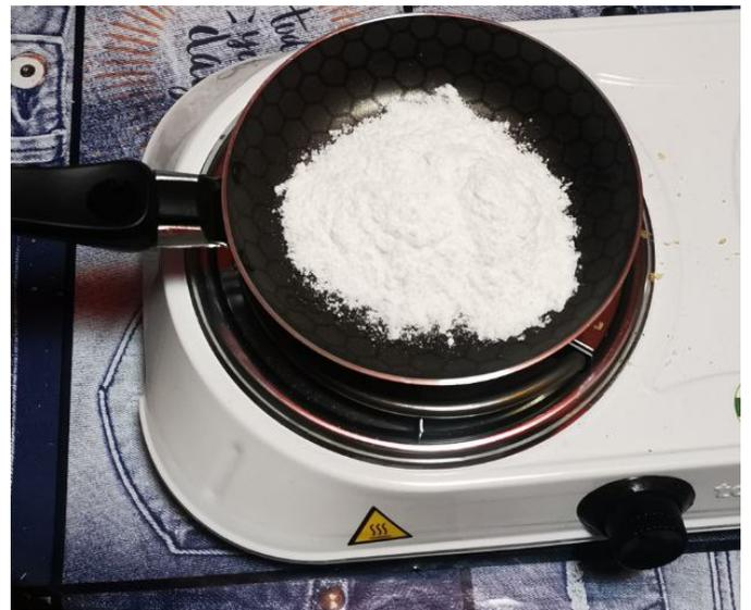
Figura 4.9: Colocamos la mezcla en polvo de azúcar y nitrato de potasio en el sartén. Por motivos de seguridad, siempre debe ser una cantidad pequeña de mezcla, 25g de la mezcla de azúcar y el nitrato de potasio.
