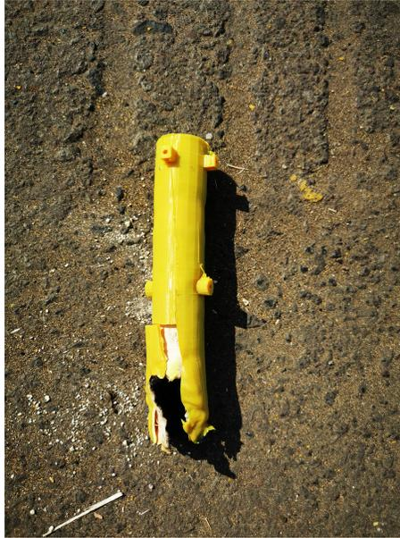
Figura 7.14: Cilindro de PLA que sufrió una deformación considerable por la temperatura.
