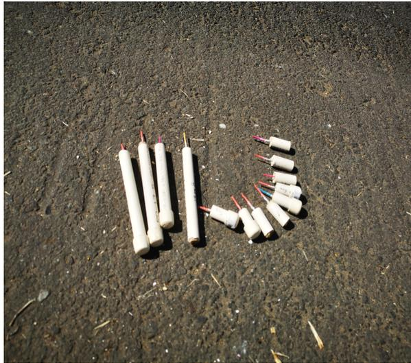
Figura 7.3: Foto de algunos cartuchos utilizados, con la mecha ya colocada.
