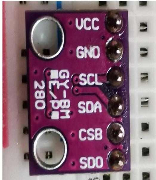
Figura 5.10: Fotografía del PCB con el sensor BMP280. Pueden distinguirse fácilmente el nombre y ubicación de sus pines.
