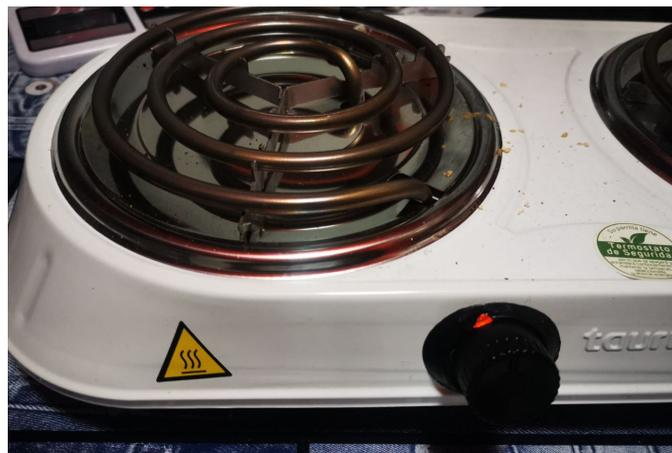
Figura 4.7: Se enciende uno de los quemadores de la parrilla eléctrica, colocando la perilla en la 3a posición y se le permite al filamento llegar a una temperatura media.
