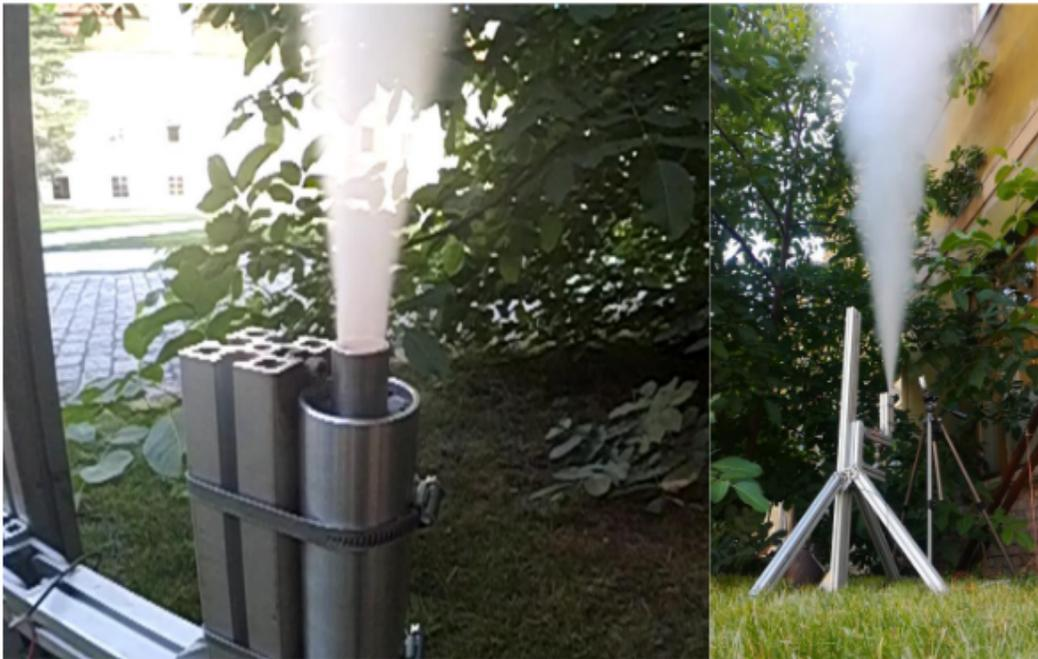
Figura 2.8: Dispositivo que Michal Málek utilizó para evaluar el empuje de su motor. Imagen recuperada de [10].
