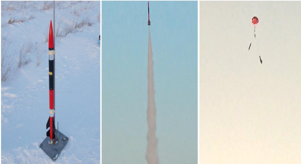
Figura 1.4: Fotografías del Cohete DS: antes de despegar, en vuelo, y con el sistema de recuperación desplegado. [6]
