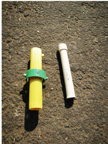
Figura 7.13: Recuperación cilindro impreso en PLA junto con el proyectil después de la combustión.
