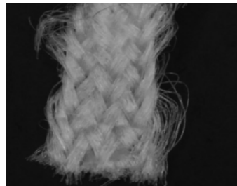
Fig. 25. Descripción grafica del sistema tejido de las fibras Ribbond®. (17)
