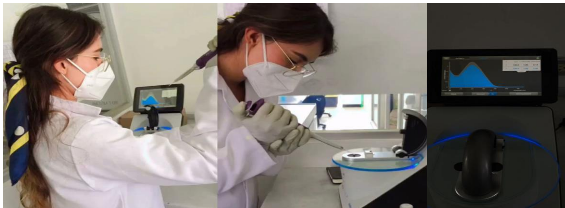
Imagen 2. Cuantificación y comprobación de pureza del material genético extraído con un espectrofotómetro NanoDrop
