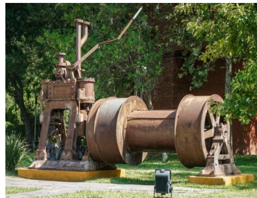
Figuras 83 y 84. A la izquierda el malacate de sangre y a la derecha el malacate de vapor (imágenes obtenidas de https://www.proyectoarrayanes.org/ y https://www.parquefundidora.org/ respectivamente).
