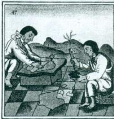
Figuras 37 y 38. Fundición, laminación y aplicación de la cera
