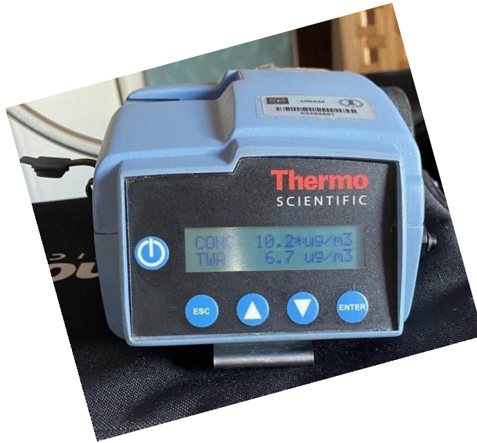
Figura 11. Fotografía de instrumento pDR-1500 utilizado para monitorear PM 2.5 en los transportes seleccionados en la CDMX.
