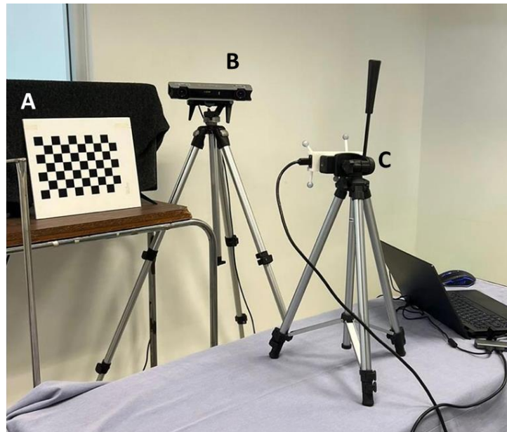
Figura 26: Adquisición de poses de cámara a través de determinación de su posición por los parámetros de calibración y de poses físicas de cámara determinada por el seguimiento óptico. A) Chessboard o tablero de ajedrez que sirve como patrón de calibración, B) Dispositivo de seguimiento óptico, C) Cámara estéreo. A y B se mantienen fijos y C cambia de posición en cada toma.
