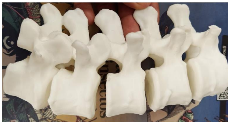
Figura 16: Impresión 3D en PLA del modelo de vértebras lumbares obtenido a partir de la reconstrucción tridimensional.
