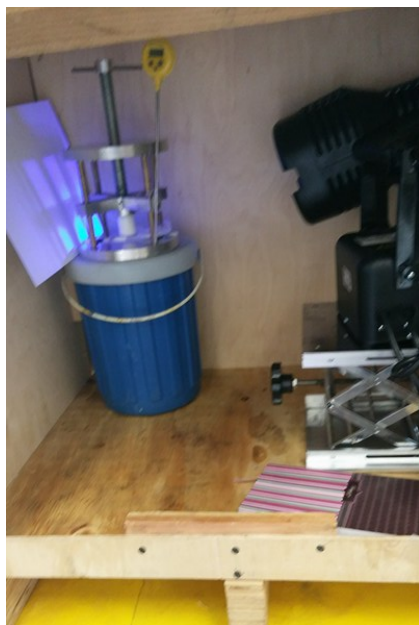
Figura 3.12: Radiación de gel comprimido en prensa de deformación.
