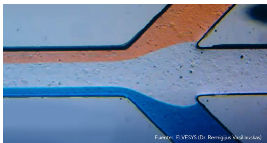
Figura 2.28: Intersección entre canal de fase dispersa y canal de fase continua en chip de microfluídica.
