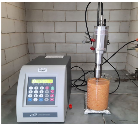
Figura 14. Ultrasonido: homogeneizador de tejidos (modelo: CV334, marca: Cole-Palmer, USA) y un procesador ultrasónico (modelo: CP505, marca: Cole-Parmer, USA).
