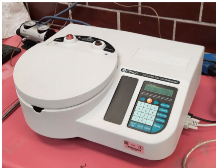
Figura 17. Cromatógrafo de gases con detector de ionización de flama (modelo 200, marca Ellutia GmbH & Co., Alemania) y una columna (modelo ZB-5, marca Phenomenex, USA).
