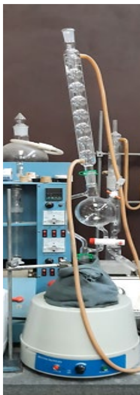
Figura 13. Equipo de hidrodestilación, empleando una mantilla de calentamiento tipo nido (marca: Prolab) con potencia de 450 W para matraz redondo de 2 L.
