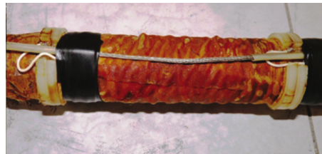
Figura 6.5: En el interior de la antena, cada segmento tiene unas 12,000 vueltas de alambre de cobre de 0.14 mm de diámetro. El diámetro exterior de cada bobina es de 31.1 mm [Sierra et al., 2014].
