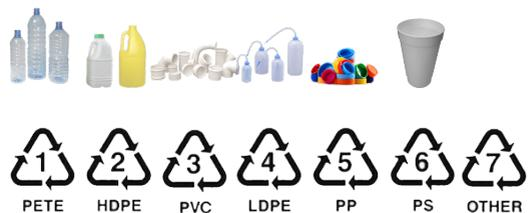
Figura 14. Ilustración de objetos fabricados con diferentes polímeros.
