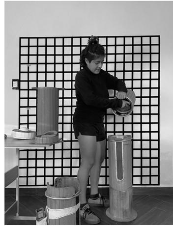
Los cambios en el compostador fue el cambio de 2 cápsulas a 1, buscando estabilidad sin descuidar la cantidad que almacenaría para el proceso de composta.
