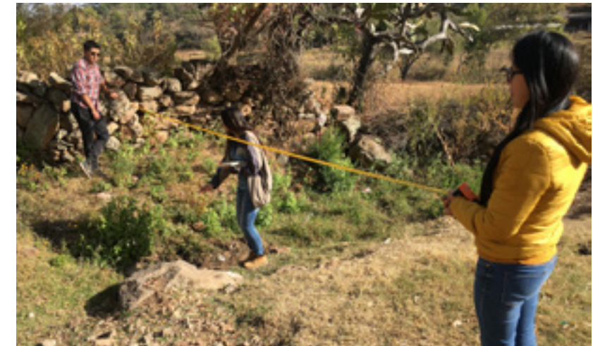
(2.3) Miembros del LAASC tomando medidas del predio de “la cruz” para su posterior levantamiento en planos y modelos 3D.
