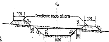
SECCION TIPO DEL CANAL
