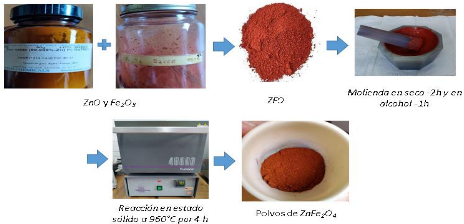
Figura 17: Esquema de la síntesis de ZnFe_2O_4
