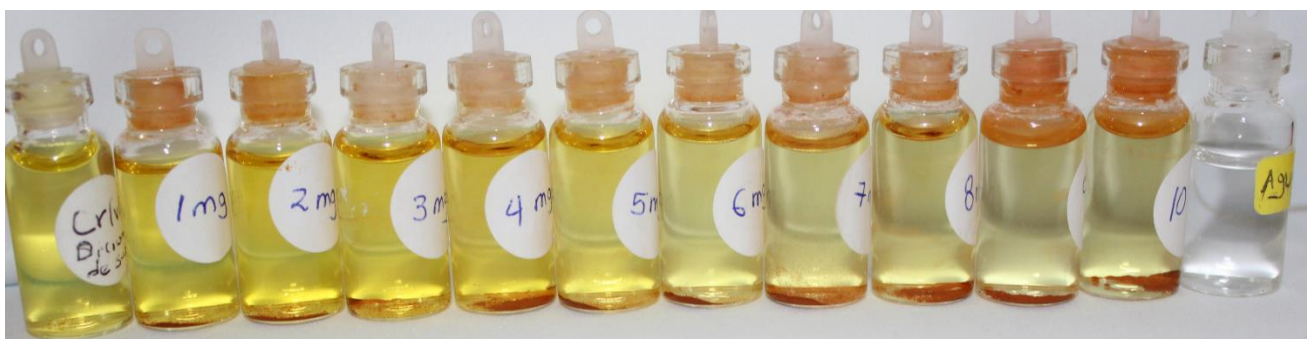
Figura 28: Cambio de coloración en las disoluciones \text{Cr(VI)} a medida que aumenta la concentración de \text{ZnFe}_2\text{O}_4 .
