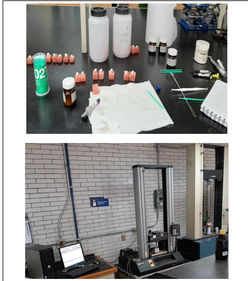
Figura. 12 La prueba de esfuerzo de adhesión al desalojo se llevó a cabo con una maquina universal de pruebas mecánicas (Instron) y una carga al punto de fractura de 1.0 mm/min.
