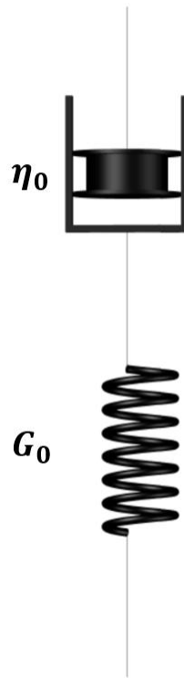
Figura 2.2. Representación del modelo de Maxwell en el cual podemos apreciar la unión de una parte viscosa y otra elástica en paralelo.
