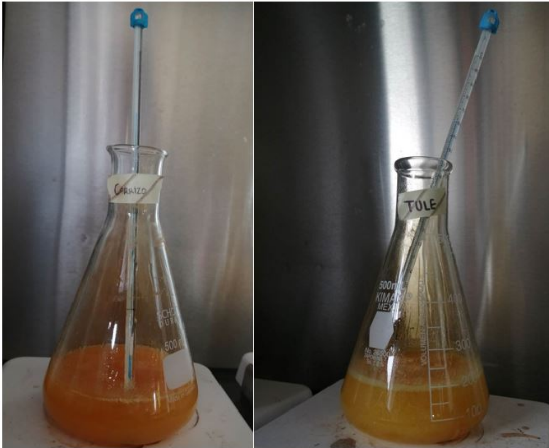
Figura 6.3: A la izquierda: Reacción de extracción de celulosa del carrizo. A la derecha: Reacción de extracción de celulosa del Tule
