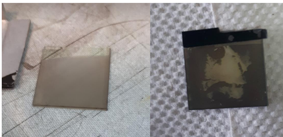
Fig 4.3. Distintos crecimientos de la película de ZnS: Mn (2+) sobre NiO: Li (10 %). A la izquierda se muestra la película de ZnS: Mn (2+) a base de metanol y dietilenglicol. A la derecha se muestra la misma película pero usando alcohol isopropílico y mayor cantidad de ácido acético lo que afecta la calidad de la película inferior.
