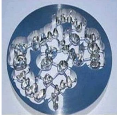
Fig. 10 Restauraciones fresadas en disco de Co- Cr. (17)
