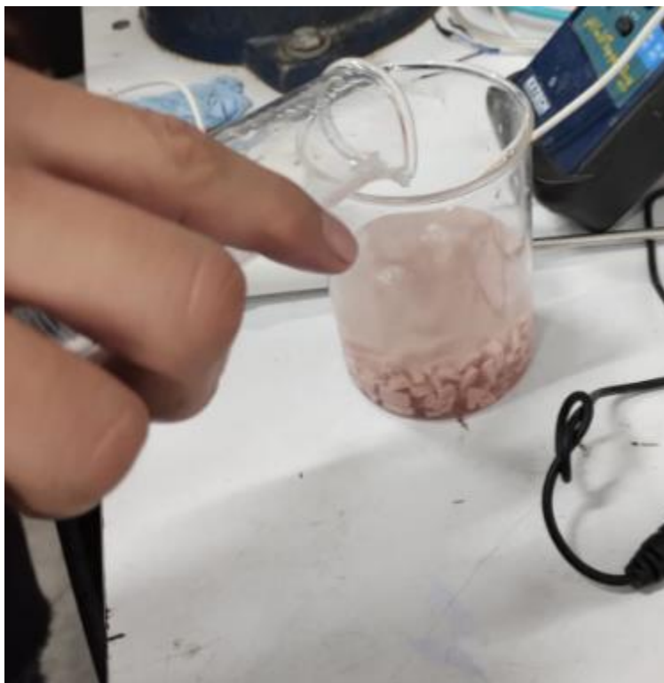
Figura 41. Preparación de la fase oral. Mezcla del alimento con saliva artificial.
