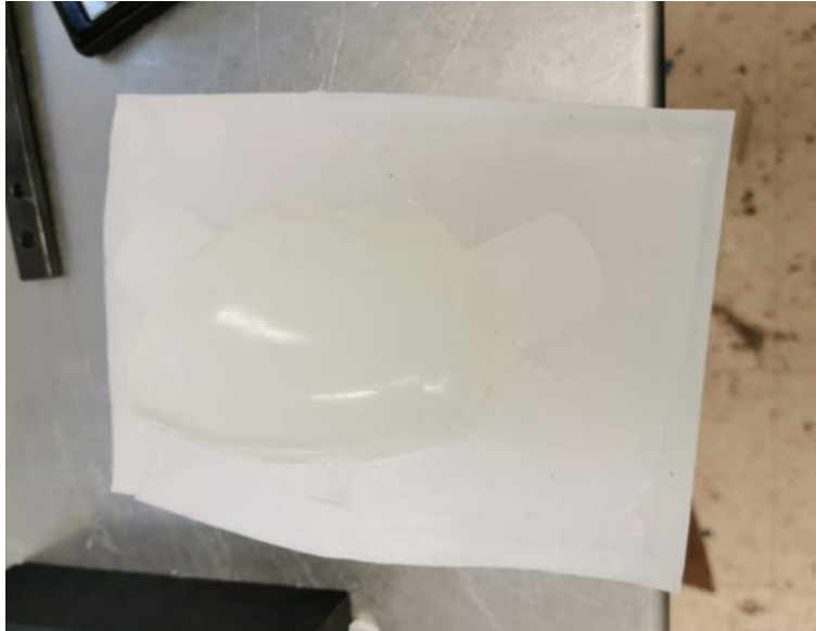
Figura 29. Molde de silicón de la pieza maestra partido a la mitad.
