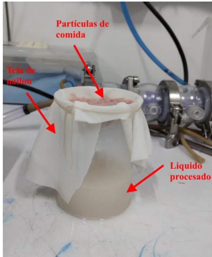
Figura 46. Proceso de separación de las partículas sólidas con los líquidos procesados.
