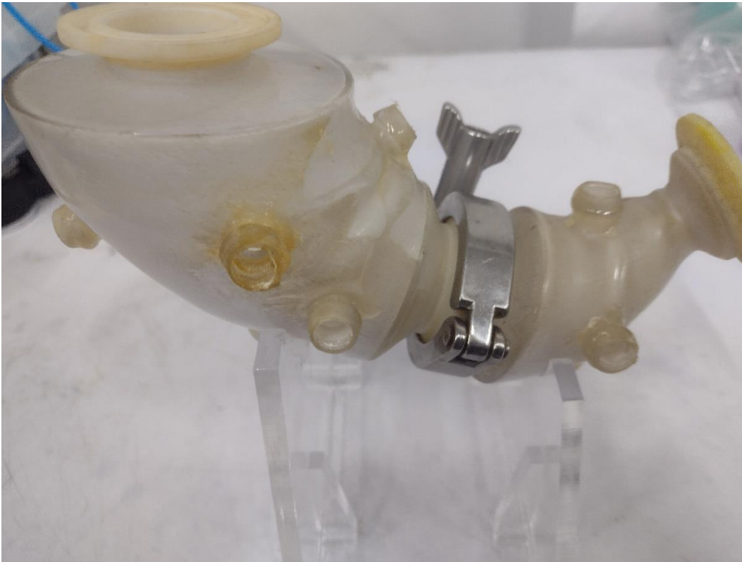
Figura 26. Desgaste del modelo gástrico IV-DGS desarrollado en el trabajo de maestría (Donis Rabanales, 2018).
