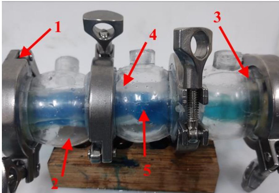
Figura 63. Ensamble final del modelo intestinal. 1) Abrazadera de acero inoxidable; 2) Cámara intestinal; 3) Cople; 4) Membrana flexible; 5) Membrana de colágeno.
