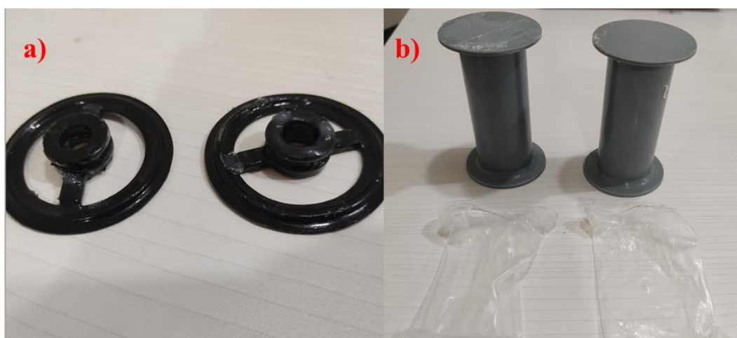
Figura 62. Fabricación del modelo intestinal: a) Coples son baño de silicón Ecoflex 00-30 (Smooth on Inc.); b) Moldes y membranas flexibles fabricadas mediante caucho de silicón Ecoflex 00-30 (Smooth on Inc.).
