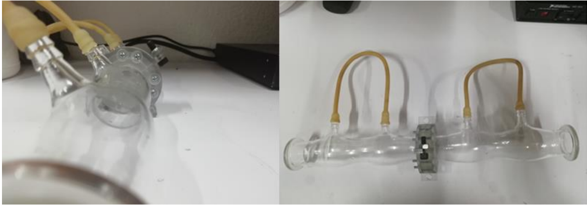
Figura 56. Unión de las cámaras mediante la brida.
