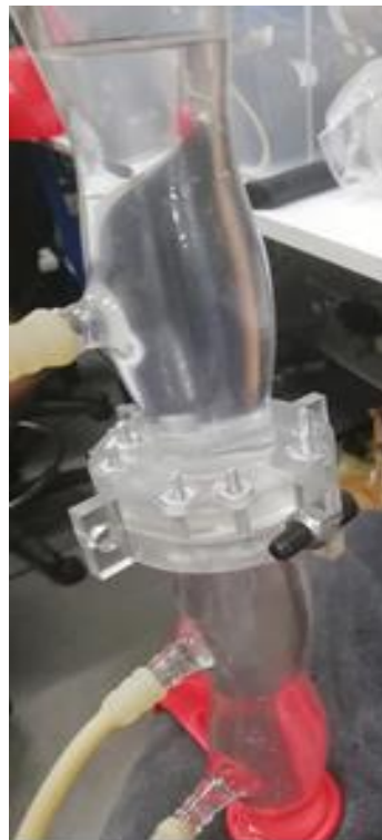
Figura 57. Análisis de fuga de agua en el prototipo intestinal.
