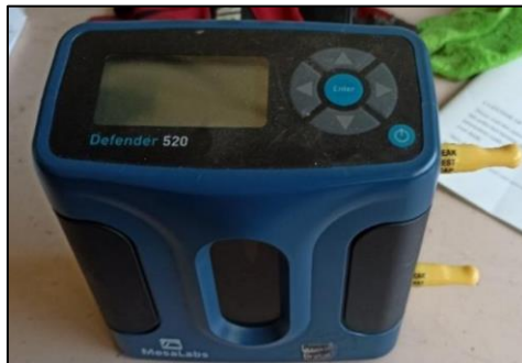
Figura 3.13. Medidor de flujo Defender 520. Nos permite calibrar el flujo de las bombas de succión.
