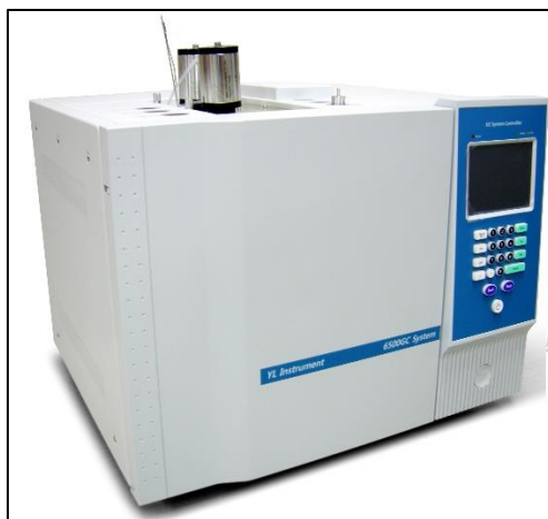
Figura 3.11. Cromatógrafo Young Lin modelo 6500. Este equipo fue utilizado para medir las concentraciones del metano y los compuestos no metánicos.
