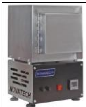
Figura 3.5. Mufa marca NOVATECH modelo MD-20. En la que se llevaron a cabo las pruebas para determinar el porcentaje de cenizas y materiales volátiles.
