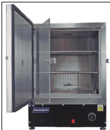
Figura 3.5. Mufa marca NOVATECH modelo MD-20. En la que se llevaron a cabo las pruebas para determinar el porcentaje de cenizas y materiales volátiles.
