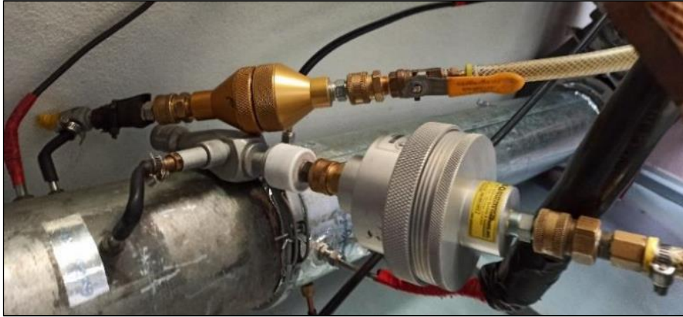
Figura 3.12. Sistema gravimétrico PEMS. Permite obtener las muestras de las concentraciones del material particulado.
