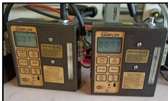
Figura 3.14. Bombas de succión. Estas fueron utilizadas para obtener la succión necesaria en los trenes de muestreo de las emisiones atmosféricas y las emisiones intradomiciliarias respectivamente.
