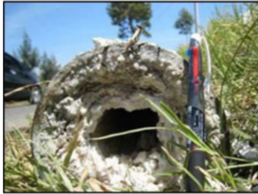
Figura 2.1: Fotografía de la precipitación de sílice típica en una tubería de reinyección del sistema geotérmico de Dieng en Indonesia (Pambudi, et al, 2015)
