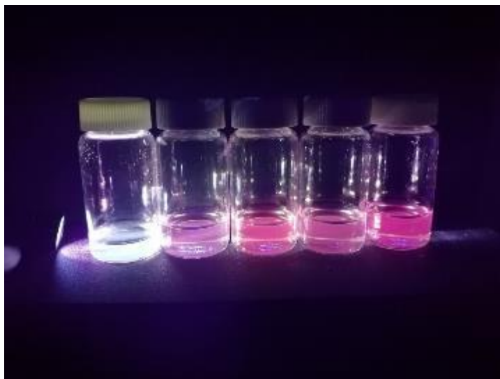
Ilustración 28. Excitación con luz UV de las soluciones de AC con nitrato de europio.
