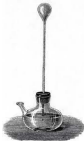
Ilustración 01. Termoscopio de Galileo [5].
