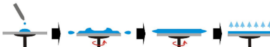
Ilustración 24. Técnica de recubrimiento por rotación.
