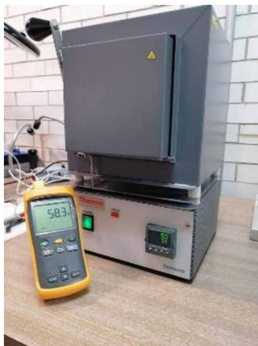
Ilustración 32. Sistema de medición de temperatura.
