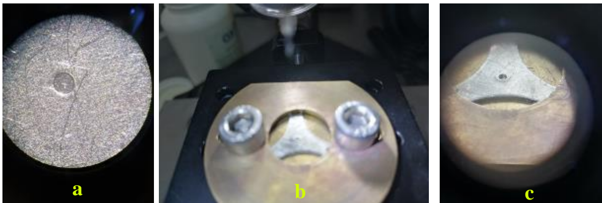
Ilustración 16. Proceso de perforado de gasket.
