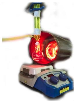
**Imagen 21.** Equipo de irradiación infrarroja.
