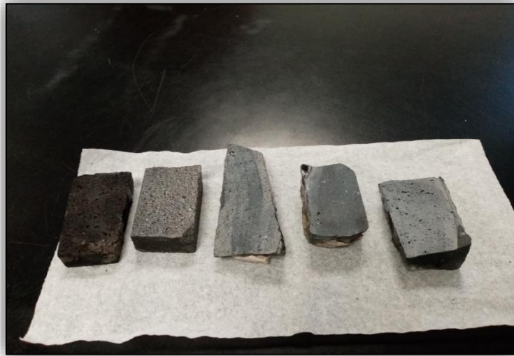
Figura 19. Fotografía de fragmentos de las muestras seleccionadas para elaborar láminas delgadas y/o pulidas.
