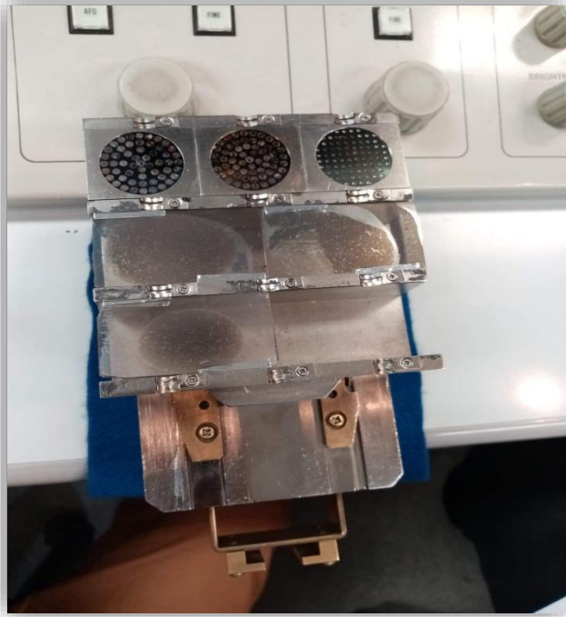
Figura 20. Montado de los estándares y de las secciones pulidas para su análisis cuantitativo empleando la microsonda electrónica.
