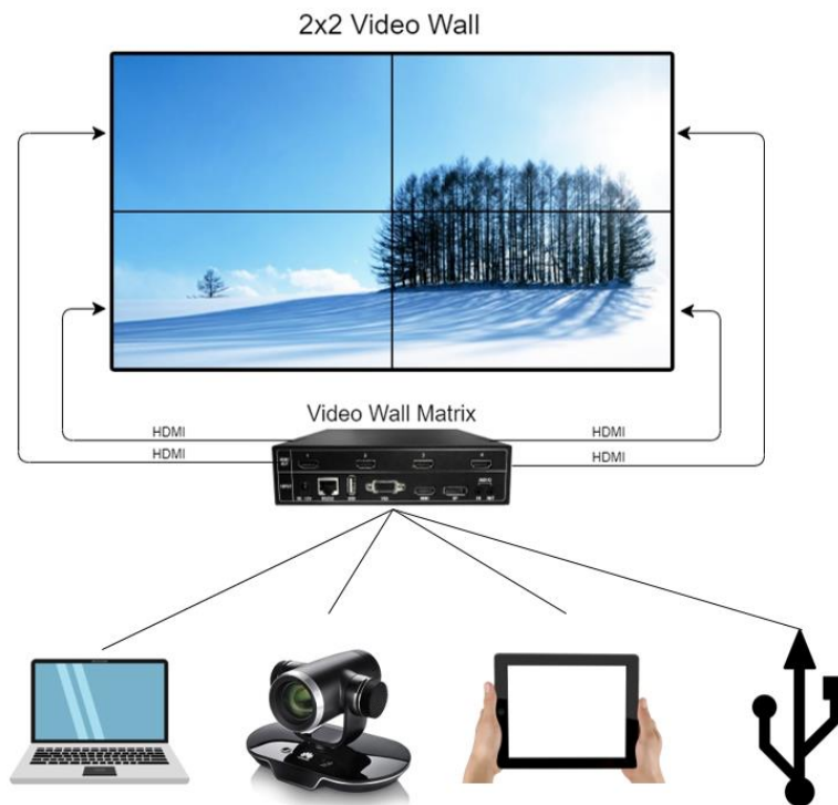
Figura 4.12 Matriz de Video Wall 2x2 con fuentes de video
