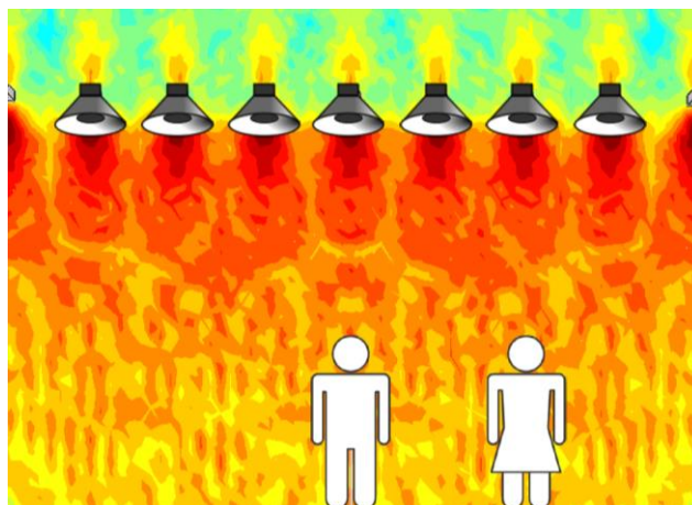
Figura 7.10 Sembrado de altavoces de alta densidad
