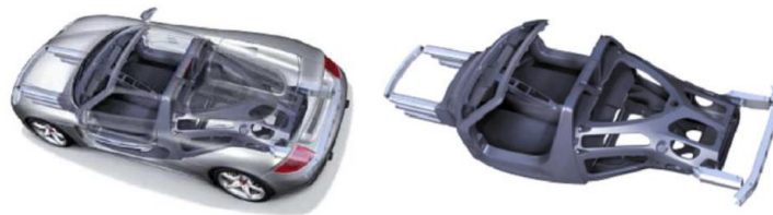
Ilustración 2-4- Estructura de compuesto polimérico en la celda de pasajeros de un Porsche Carrera GT [15]
