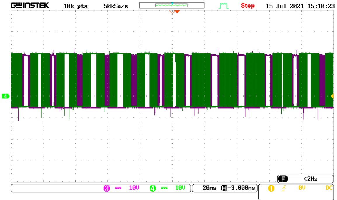
Figura 45 Señal de control SPWM a partir de la DSP
