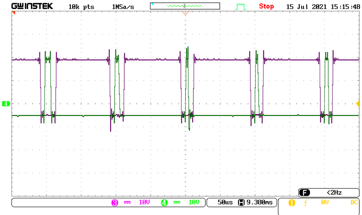
Figura 49 Otro Acercamiento de la Señal de control SPWM a partir de la DSP
