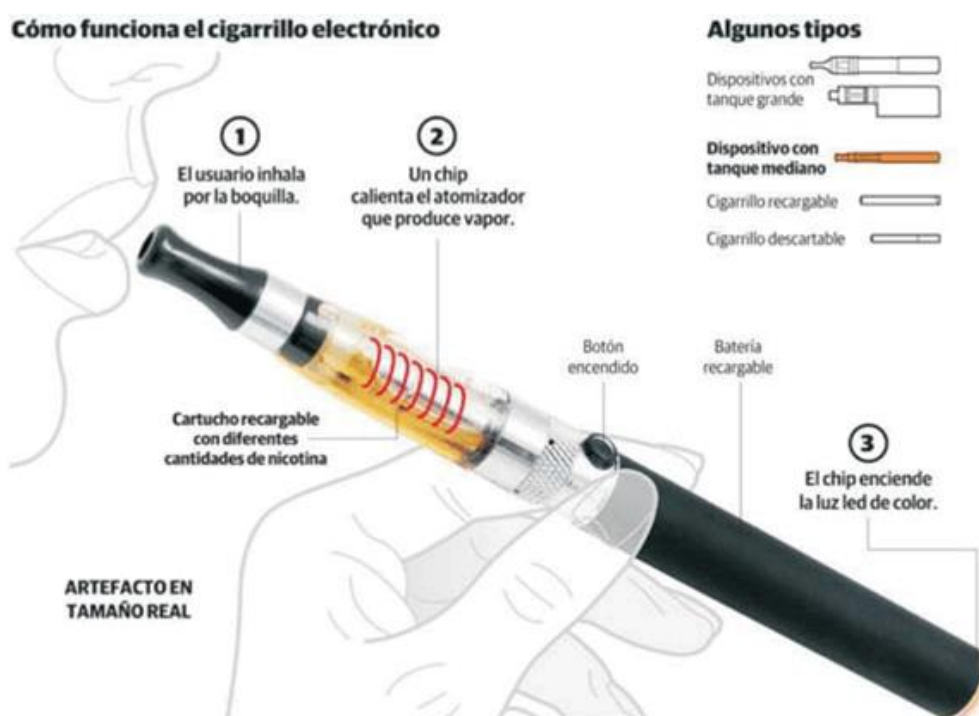
Imagen 35: Partes de un cigarrillo electrónico. 35
