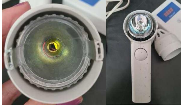
Figura 7. Filtro óptico y bombillo (Fuente propia)
