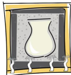
*Estructura del embalaje y empaque absorben la energía del impacto para que no llegue a la pieza.*
