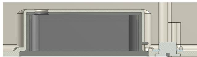
**Corte del broche desbloqueando el contenedor de batería.**
