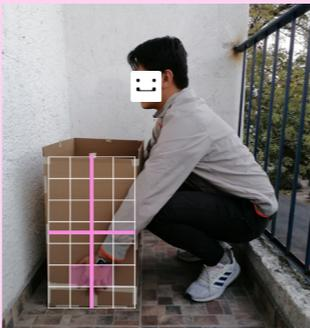
**CON PESO:** La propuesta no se probó con peso, pues al observar que el alto de la caja podría ocasionar accidentes al usuario que la levantara, se descartó.
