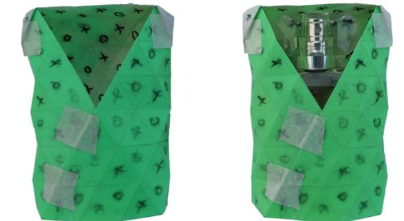
*Empaque de dos láminas triangulares reticuladas: Envolviendo un perfume de 50 x 95 x 30 mm.*
