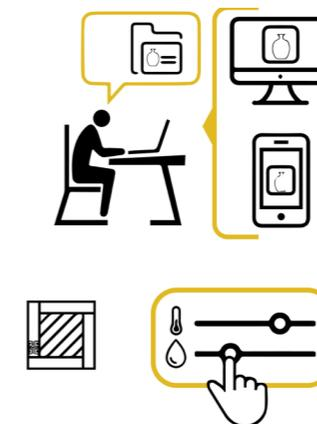
Sensores en el embalaje permitirán conocer la temperatura y humedad dentro del embalaje, con lo que automáticamente se ajustarán las fuentes de calor, humedad, aire, etc, para mantener los valores aptos para la conservación de las piezas.
