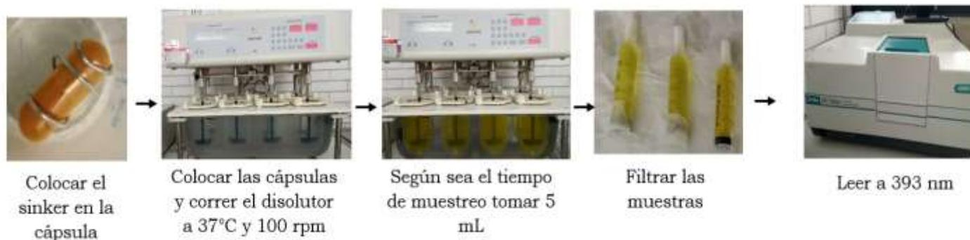
**Figura 15. Procedimiento experimental de los perfiles de disolución.**
