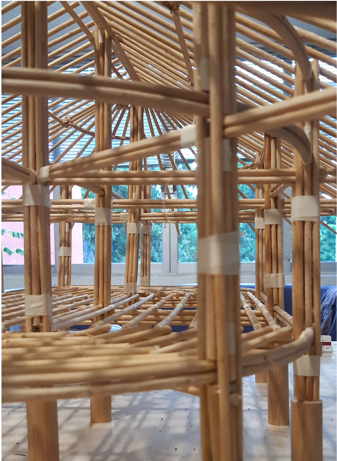
Figura 6.1 Fotografía de maqueta estructural de propuesta conceptual de una eco-vivienda Ėk ben ja' . Fuente: Autor. Año: 2022.
