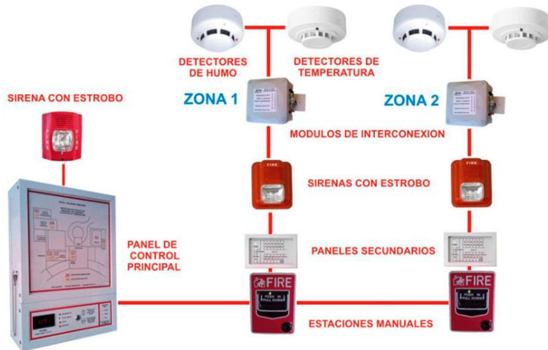
Imagen 35 Diagrama ilustrativo de Funcionamiento de Sistema Contra Incendios, obtenido de FUEGO, T. (2005). Catálogo de Industria y Construcción. TECNOFUEGO
