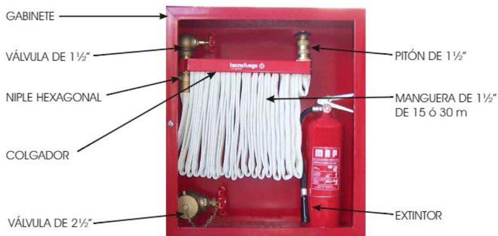
Imagen 32 Gabinete de Manguera y Extintor, obtenido de FUEGO, T. (2005). Catálogo de Industria y Construcción. TECNOFUEGO
