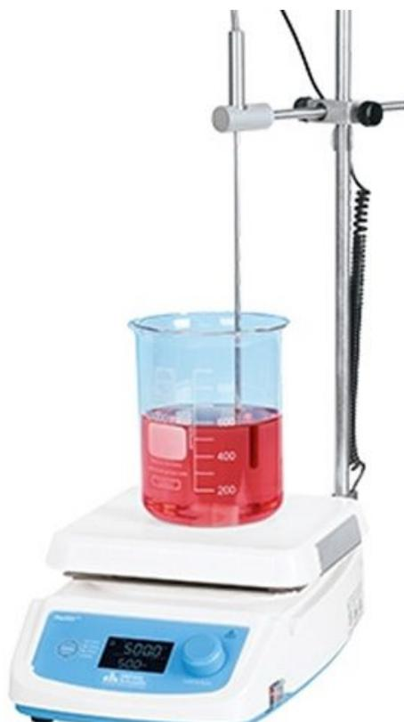
**Figura 31.** Equipo de agitación magnética con calefacción (Cienytech, 2016).
