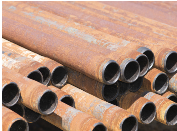
Figura 3.2. Tuberías de acero sufriendo de corrosión generalizada [9]
