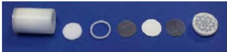
**Figura 16 diagrama interno del muestreador Ogawa
