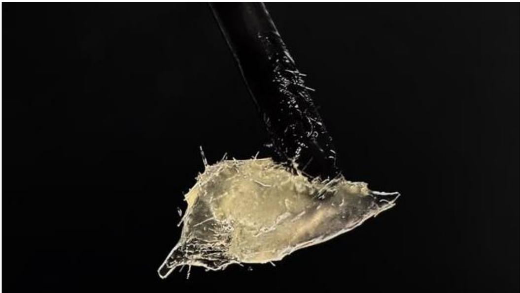
**Imagen 2.** Composite reforzado con fibra de vidrio.
