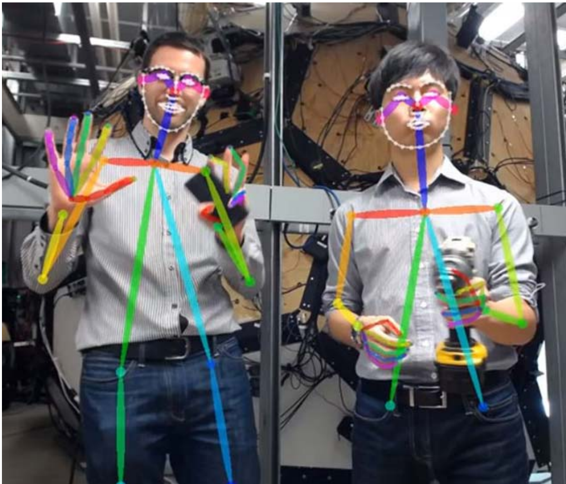
Figura 2.7: Pose de varias personas obtenida utilizando OpenPose, se observa cómo dibuja un esqueleto y la silueta del rostro, imagen tomada de [15].
