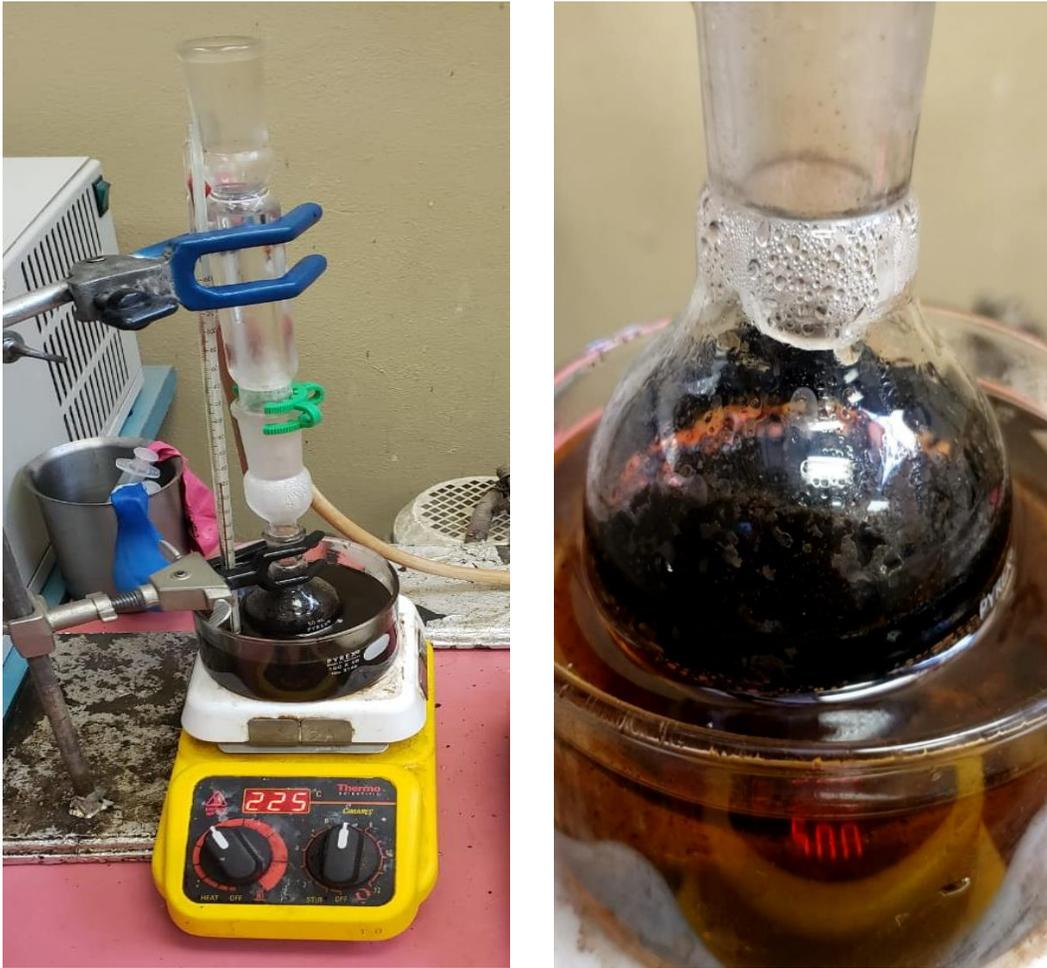
**Fig. 32. Equipo experimental para la reacción de licuefacción del grano de café gastado (izq.) y comienzo del reflujo en el matraz de reacción (der.).**
