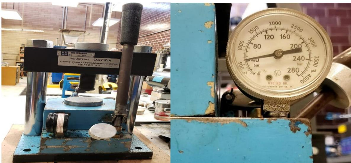
**Fig. 36. Prensa y manómetro utilizados para la medición de resistencia al esfuerzo para las placas sólidas generadas a partir de la licuefacción del grano de café gastado.**
