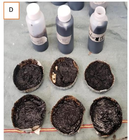
**Fig. 33. A, B, C y D materiales obtenidos a partir de la licuefacción del grano de café gastado. A, placas obtenidas de la reacción de licuefacción utilizando ácido benzoico; B, placas obtenidas de la reacción de licuefacción utilizando ácido oxálico; C, placas y productos líquidos obtenidos de la reacción de licuefacción utilizando ácido acético; D, materiales resinosos y líquidos obtenidos a partir de la reacción de licuefacción utilizando ácido láctico.**
