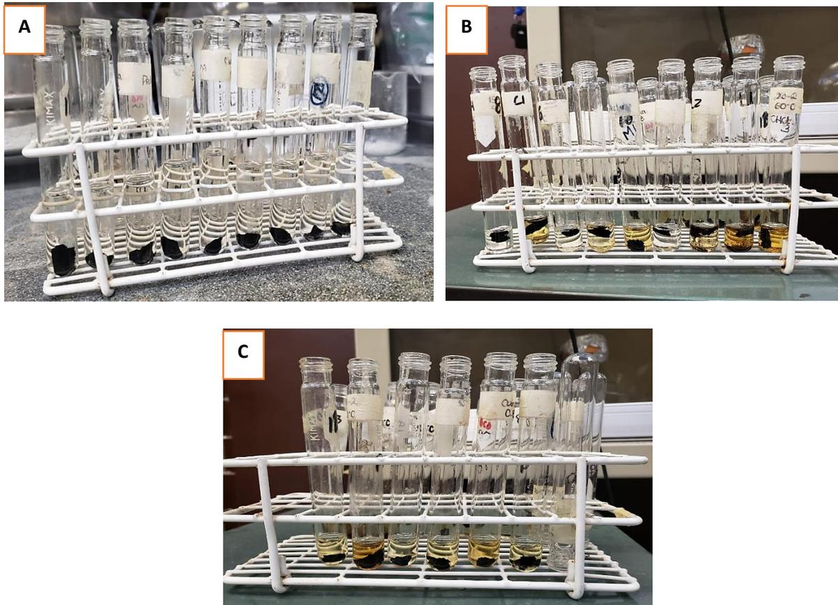
**Fig. 35. A, B, C, imágenes de varias muestras en agua de los materiales de la reacción de licuefacción del grano de café gastado. A, materiales derivados del ácido benzoico como disolvente en la reacción de licuefacción; B, materiales derivados del ácido oxálico como disolvente en la reacción de licuefacción; C, materiales derivados del ácido acético como disolvente en la reacción de licuefacción.**
