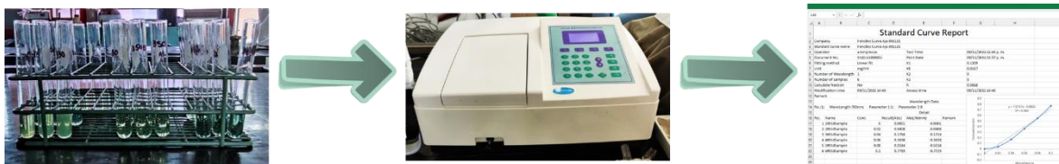
Figura 16. Procedimiento del método para fenoles totales.
