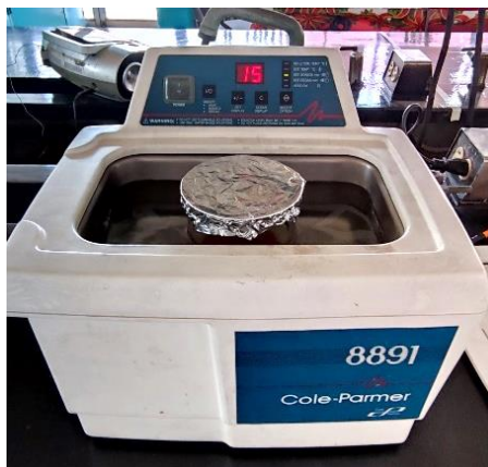
Figura 13. Extracción asistida por ultrasonido para la obtención de extracto de ajo.
