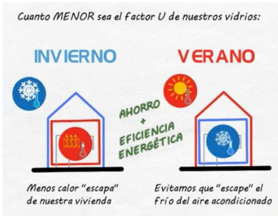
Fig. 38 Transmision termica en vidrios
