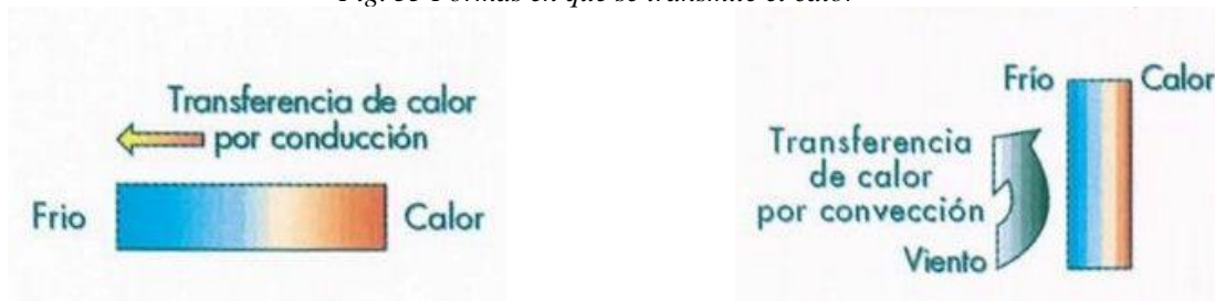
Fig. 35 Formas en que se transmite el calor
