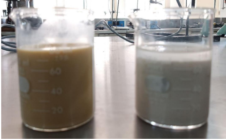
Figura 5 El fluido de emulsión inversa, el de la izquierda muestra menor separación de fases después de un día de no recibir agitación alguna
