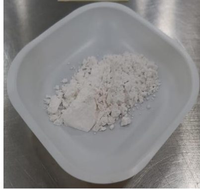
Figura 12 Barita, Sulfato de Bario, material densificante pulverizado a tamaño coloidal.
