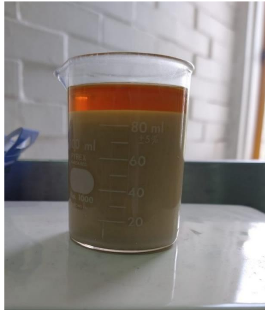
Figura 2 Fluido de perforación de emulsión inversa después de 48 horas sin agitación.
