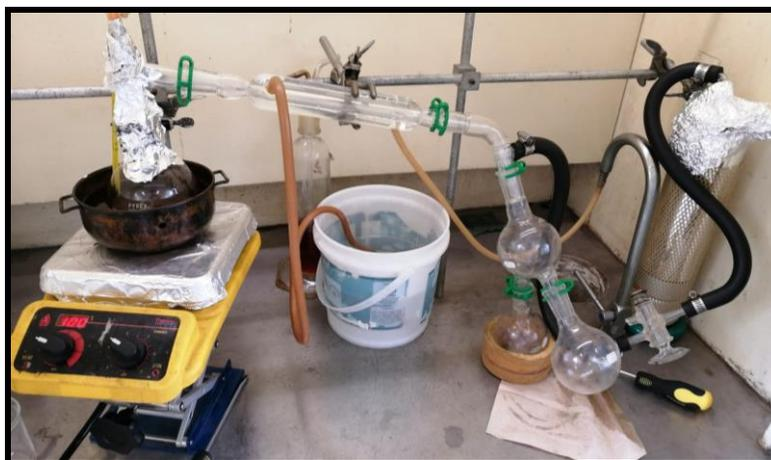
Figura 17. Montaje experimental para la destilación a presión reducida del ácido metacrílico.
