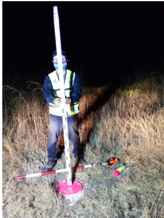
Figura 27. Posicionamiento altimétrico de bancos de nivel.
