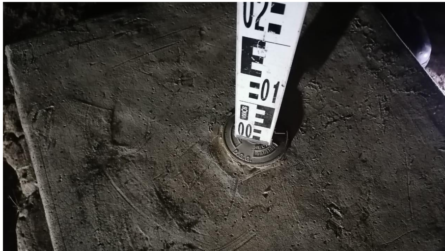
Figura 4. Inicio de nivelación en banco de nivel maestro ubicado en la base de la torre de control del aeropuerto.
