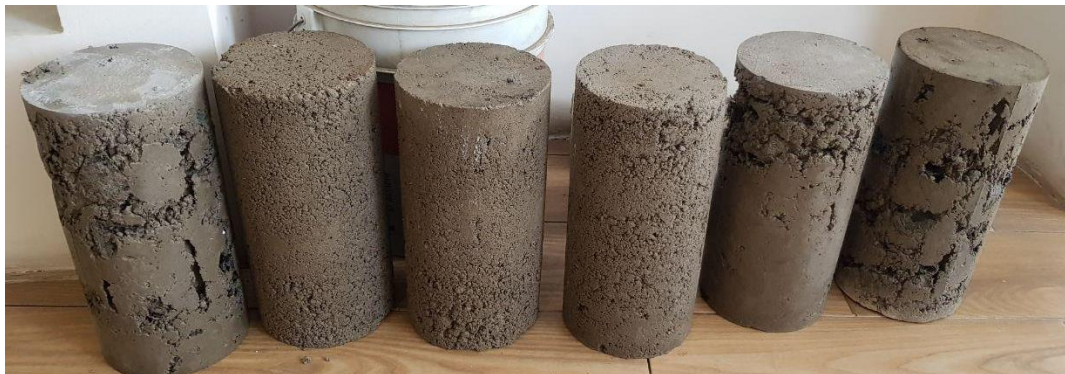
Imagen 24: Cilindros elaborados con el primer diseño de mezcla
