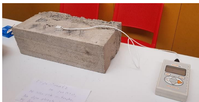
Imagen 45: Prueba de conductividad térmica / capacidad calorífica volumétrica Neublock
