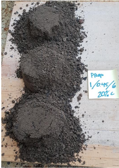
Imagen 23: Diseño de mezcla con relación A/C 0.45
