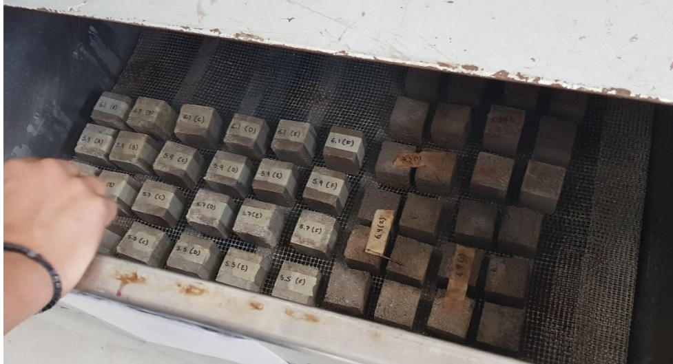
Imagen 30: Probetas en cámara de curado acelerado
