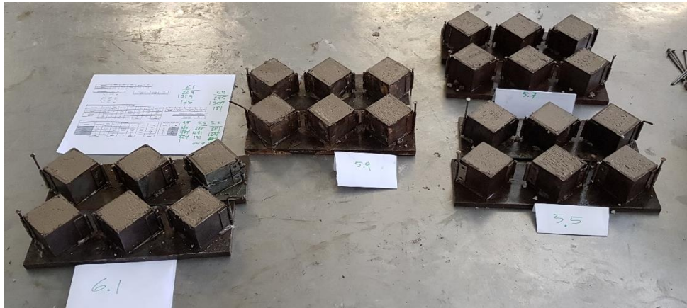
Imagen 28: Probetas con distintas relaciones Arena-Cemento
