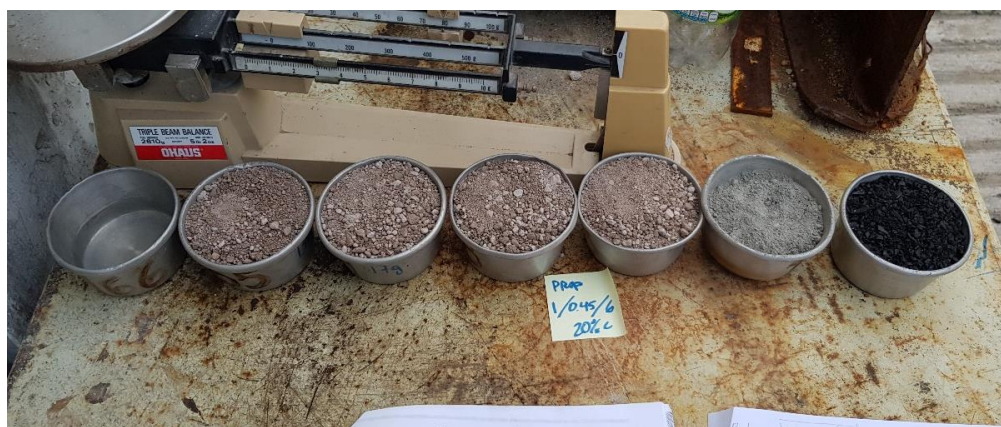
Imagen 21: Diseño de mezcla con relación A/C 0.45
