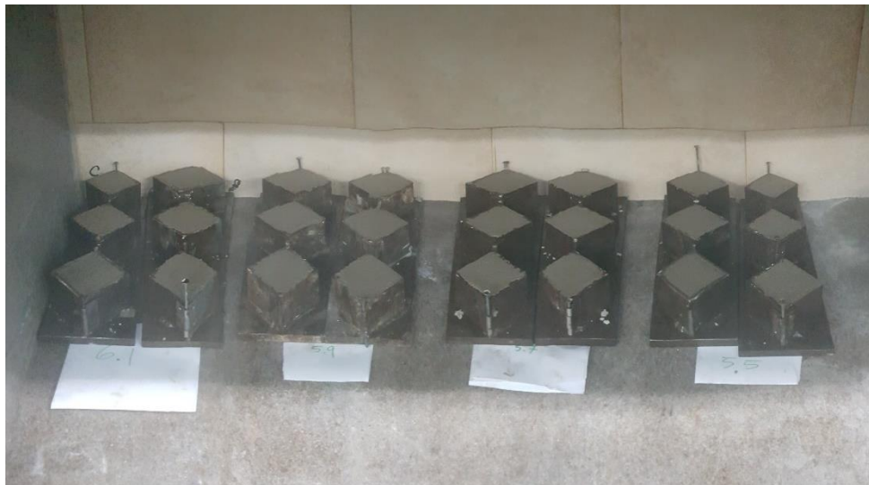
Imagen 29: Probetas en cámara de fraguado
