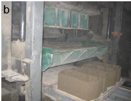
Imagen 19 b y c: Blocks y ladrillos con caucho generados en fábrica para investigación. Fuente: E. Sodupe-Ortega et al (2016)
