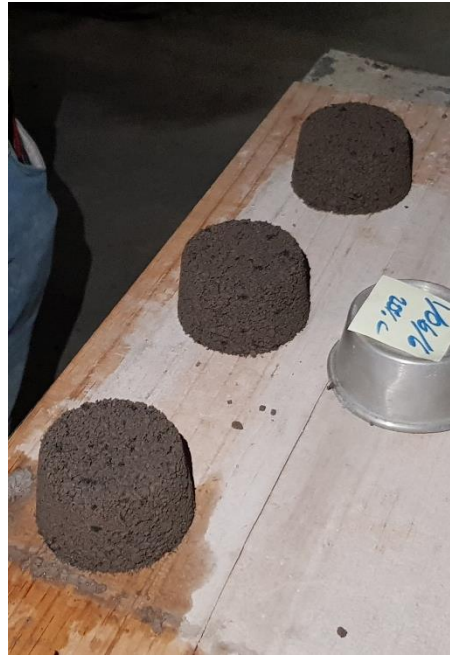
Imagen 22: Diseño de mezcla con relación A/C 0.60
