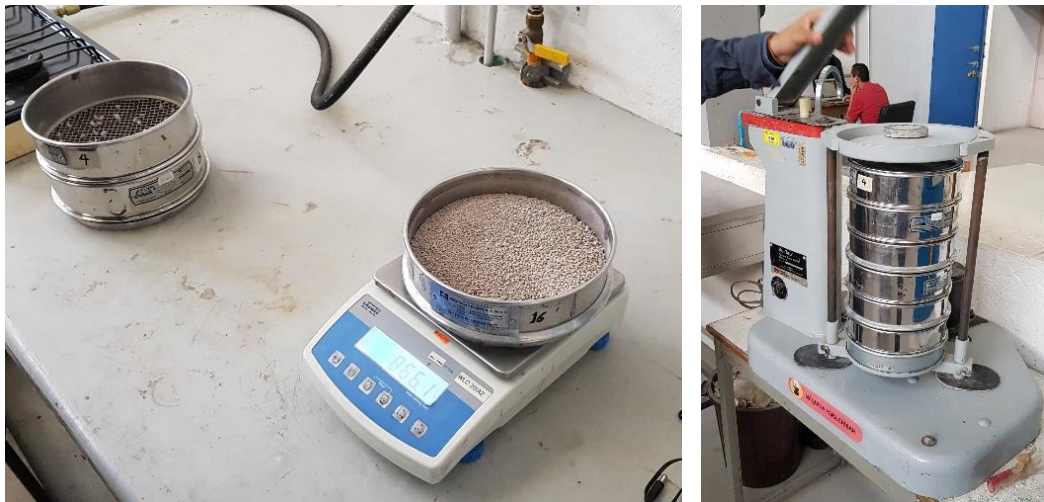
Imagen 26: Prueba de Granulometría a arena de mina en el Laboratorio de Materiales, UAM Azcapotzalco
