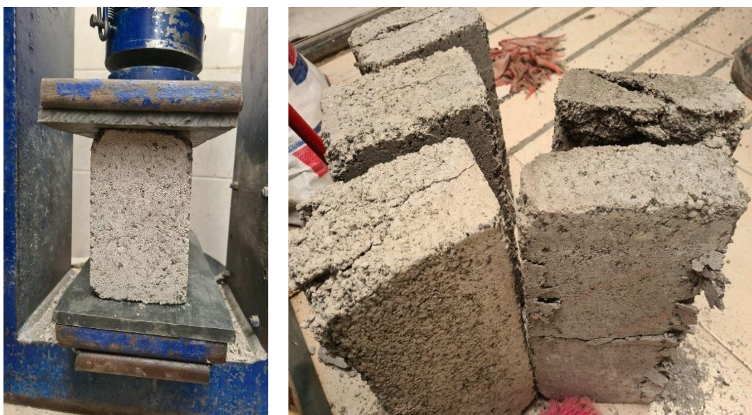
Imagen 40: Prueba de compresión en blocks
