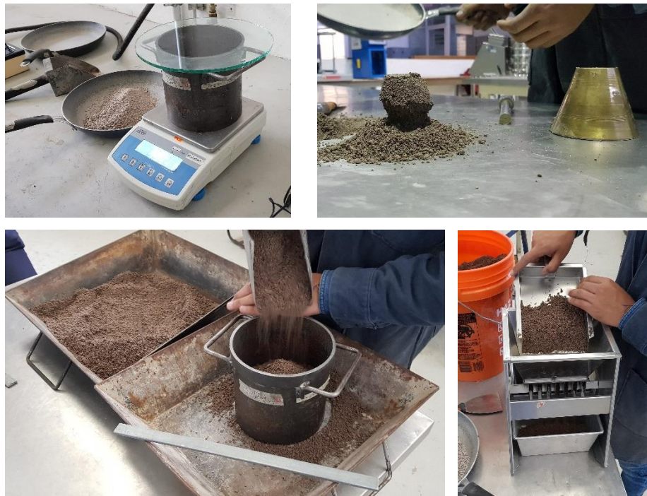
Imagen 27: Pruebas físicas realizadas a la arena de mina en el Laboratorio de Materiales, UAM Azcapotzalco
