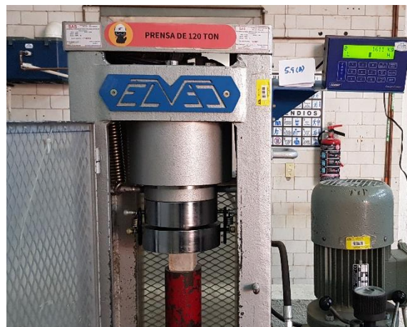
Imagen 31: Prueba de compresión en probetas
