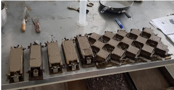
Imagen 32: Probetas con distintos porcentajes de caucho
