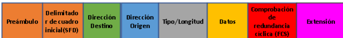
Figura 1.13. Formato de estructura de Trama para el estándar Ethernet [35].
