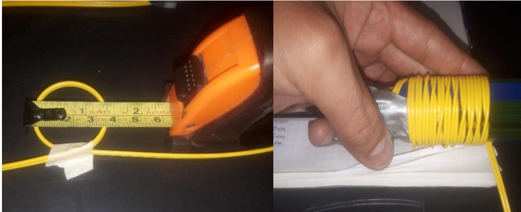
Figura 3.7 Implementación física para ejercer curvaturas en la red de fibra óptica de 21 Km.
