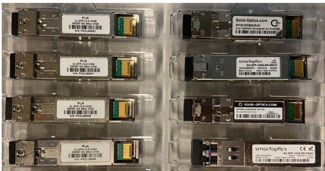
Figura 1.7. Todos los tipos de SFP+ coloreados DWDM que se utilizaron en la implementación del fronthaul.
