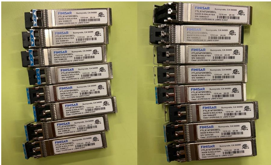
Figura 1.8. SFP+ grises que operan a 1310nm que se utilizaron en la implementación del fronthaul.
