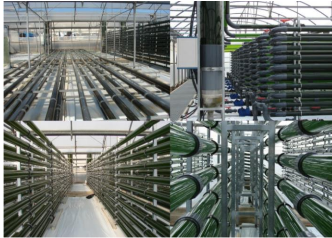
Figura 14. Fotobiorreactor tubular ubicado en Cajamar (González, 2016)
