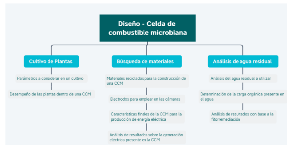
Diagrama 2. Parámetros que se consideraron en el diseño de una celda de combustible microbiana.
