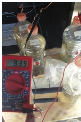
Figura 33. Evaluación del voltaje de la CCM, con ayuda de un multímetro
