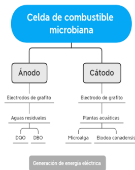
Diagrama 1. Representación de los componentes de una celda de combustible microbiana.
