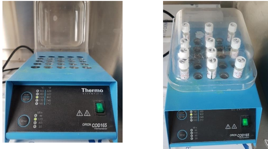
Figura 26. Termorreactor modelo Orion COD165 con viales preparados, para la prueba de DQO
