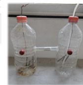
Figura 2. Construcción de una CCM.
