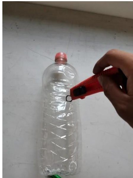
Figura 19. Corte de botella para introducir el puente de intercambio iónico.
