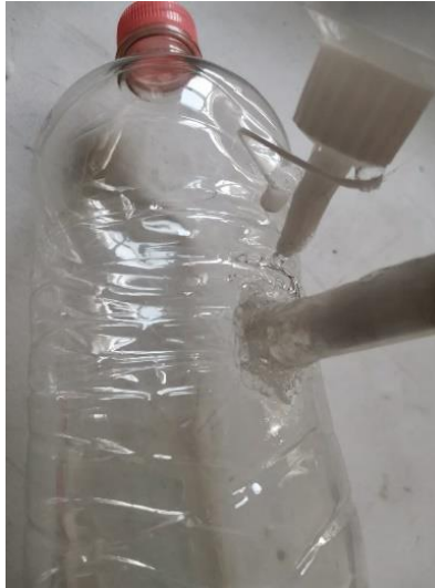
Figura 20. Unión de botella con puente de intercambio iónico
