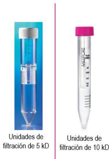
*Figura 16. Unidades de filtración empleadas en el fraccionamiento de los péptidos bioactivos.*
