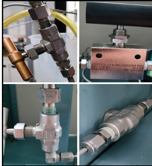
Imagen 3. Válvulas de instrumentación de diferentes tipos.
